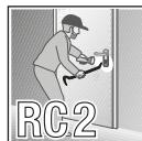
protivprovalni deo **RC 2** prema standardu DIN EN 1627:2011
