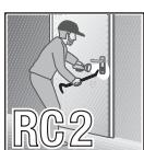
Nuo įsilaužimo sauganti konstrukcinė dalis **RC 2**, atitinkanti DIN EN 1627:2011
