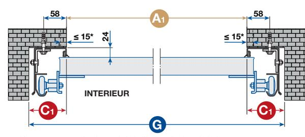
Coupe en largeur - Porte avec pattes d' ancrage spéciales
