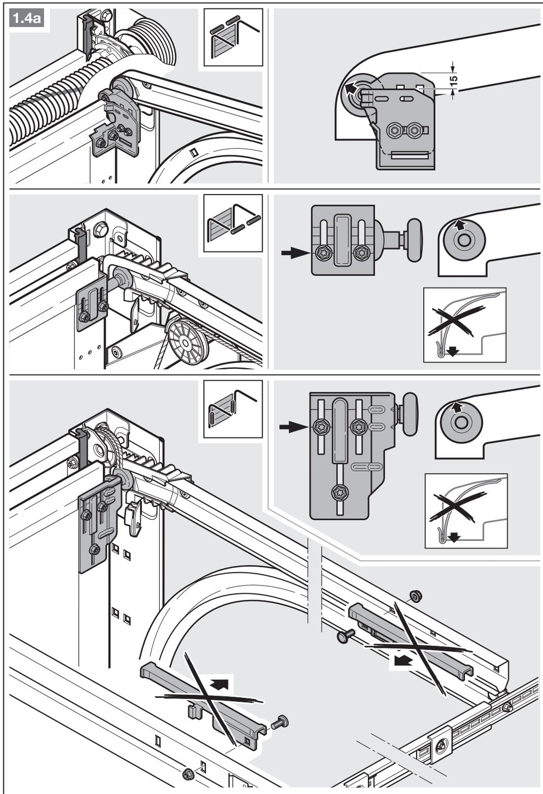
4. Pour les portes sectionnelles à serrure centrale, montez la pièce articulée de linteau et la cornière d'entraînement de manière excentrée (max. 500 mm).
