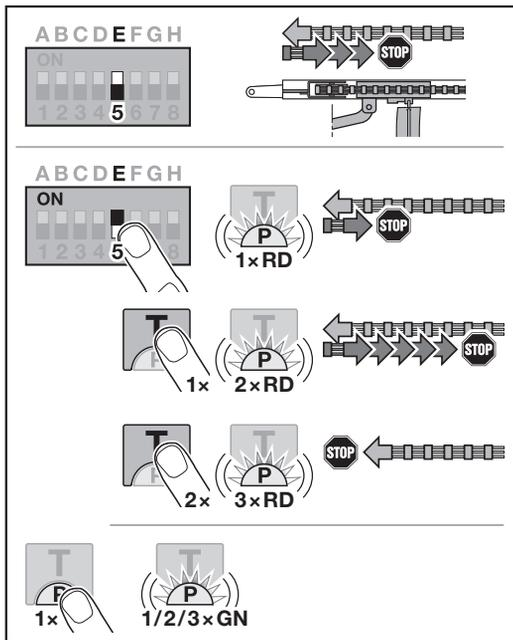
**Réglage / Modification du ménagement de la courroie :**
