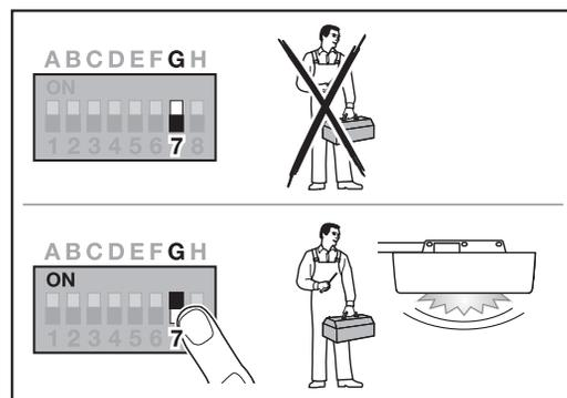
Lorsque le commutateur DIL G est positionné sur OFF (réglage d'usine), l'affichage de maintenance est désactivé. Aucun signal n'est émis.
