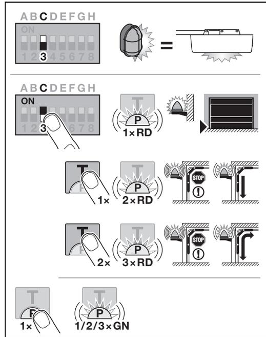
**Réglage / Modification de la fonction d'éclairage intérieur, de BUS et d'avertissement :**
