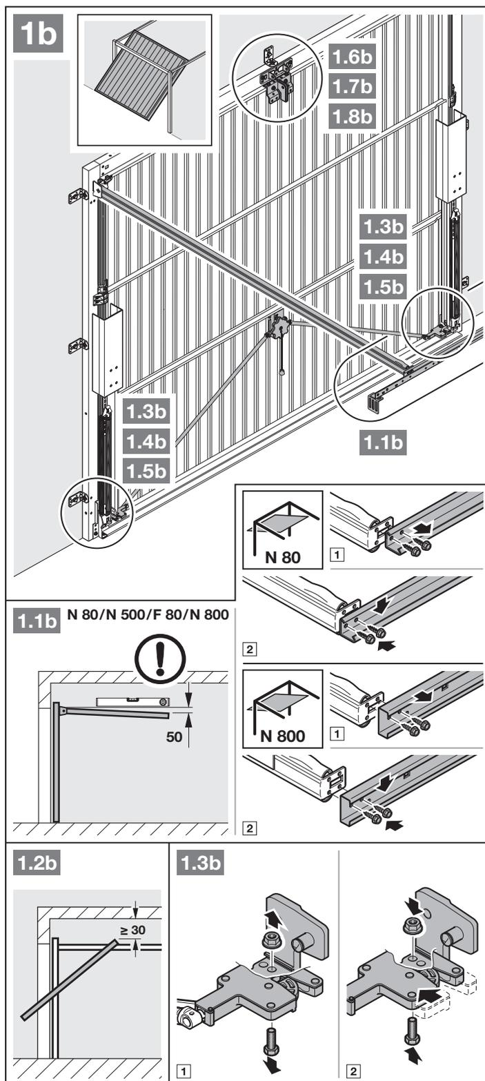
1. L'espace libre entre le point le plus haut de la porte en cours de trajet et le plafond (également lors de l'ouverture de la porte) doit être d'au **minimum 30 mm**.
