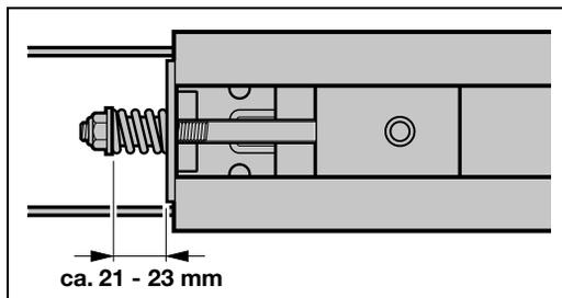
Durant la phase de démarrage et de ralentissement de grandes portes, il se peut que la sangle crantée / courroie dentée pende brièvement hors du
