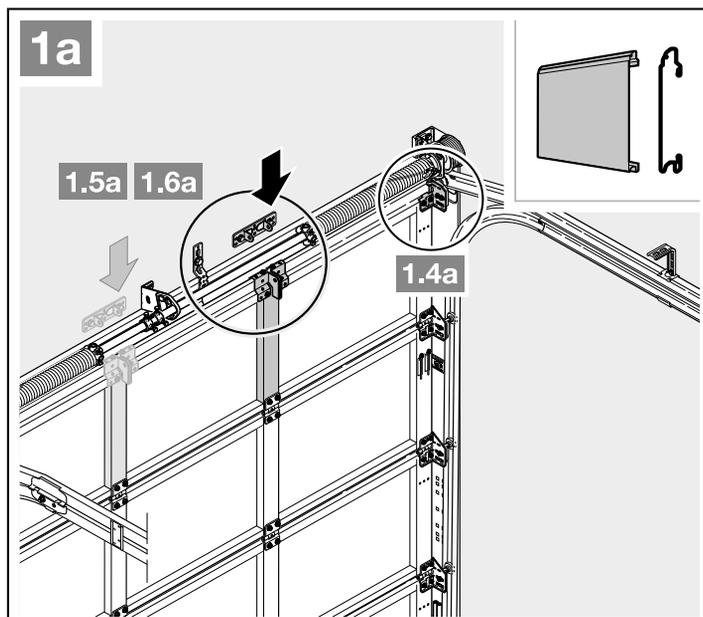
2. L'espace libre entre le point le plus haut de la porte en cours de trajet et le plafond (également lors de l'ouverture de la porte) doit être d'au **minimum 30 mm**. Pour les portes soumises à une charge thermique, la motorisation doit, au besoin, être rehaussée de 40 mm.
