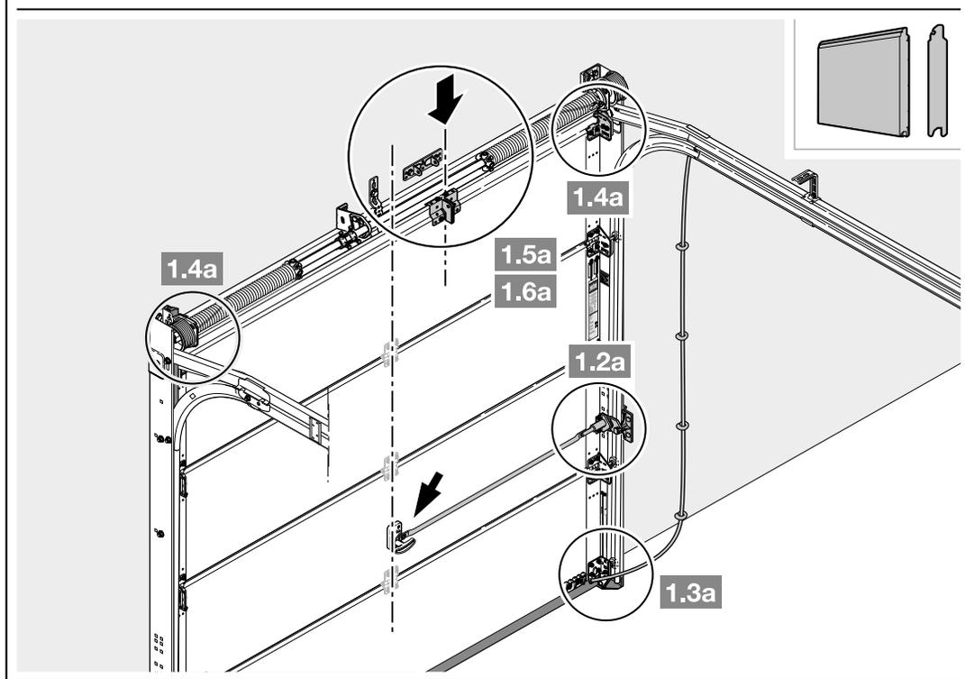
1. Pour le profil de renfort excentré, la cornière d'entraînement doit être montée à gauche ou à droite du profil de renfort le plus proche.
