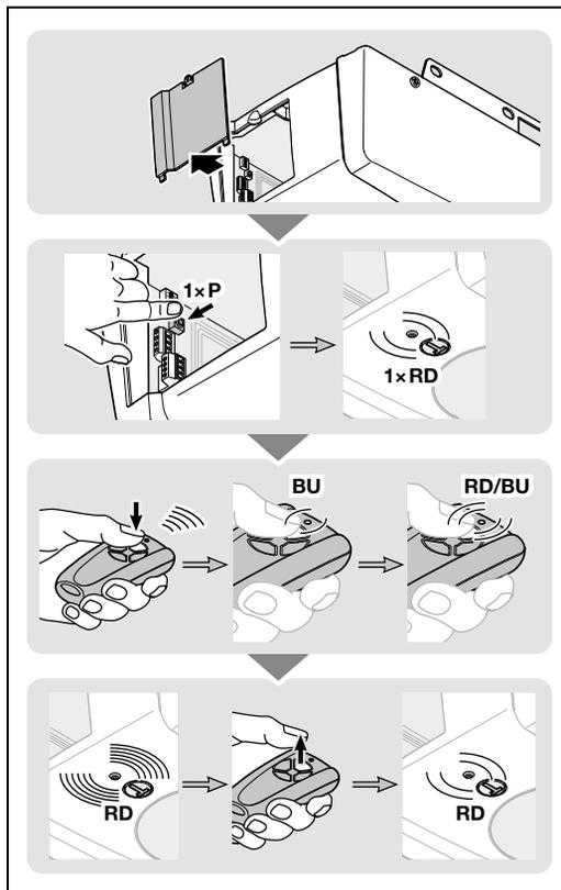
1. Retirez le couvercle du compartiment de raccordement.
