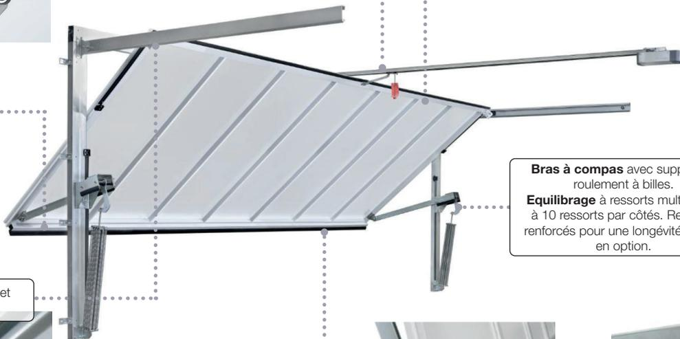
• **Tablier de porte**, structure tubulaire en acier galvanisé avec profilés extérieurs 80x60 mm et profilés médians 60x60 mm. Panneaux de tablier en acier, aluminium ou panneau fourni par l'utilisateur.
