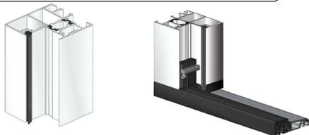
**Panneau** double paroi épaisseur 46 mm, avec recouvrement de feuillure épaisse 4 cotés, épaisseur de tôle 8/10<sup>ème</sup> de mm extérieur et 6/10<sup>ème</sup> de mm intérieur, à rupture de pont thermique, de couleur identique à l'intérieur et à l'extérieur.
