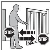
1. Retenez le portail avec les deux mains pendant que ce dernier **se ferme**. L'installation de portail doit s'immobiliser et amorcer le rappel automatique de sécurité.
