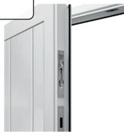
Panneau en acier galvanisé double paroi, injecté de mousse polyuréthane sans CFC, épaisseur 42 mm. Composé de plusieurs sections de même hauteur, finition extérieure associée à la porte à déplacement latéral, finition intérieure Stucco blanc similaire au RAL 9002.
