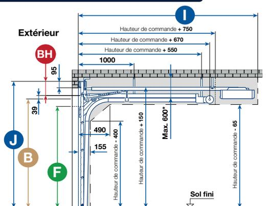
\* Suspentes d'ancrage : Hauteur sous-plafond maxi.
