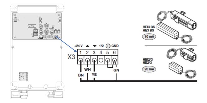
Brancher sur la borne 1 le fil brun BN pour la tension auxiliaire + 24 V CC
