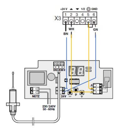
Conducteur BN: tension auxiliaire + 24 V CC
