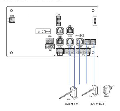
Raccordement à douille soit sur le X20 et/ou X21 :
